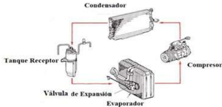
Figura 2.26. Sistema de climatización y sus componentes
