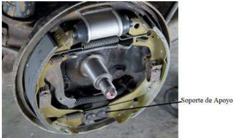
Figura 2.80. Soporte de apoyo
